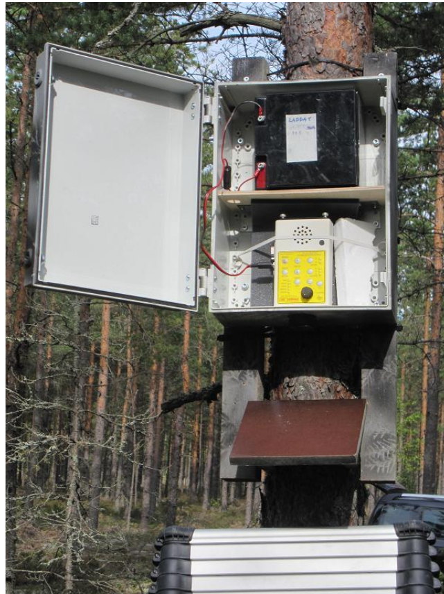
Kuva 1: Pysyvän AnaBat-detektorin suojalaatikossa oleva akku ja detektori. Detektorin mikrofoni osoittaa alaspäin ja äänet ohjataan siihen alla olevan heijastinlevyn avulla.
