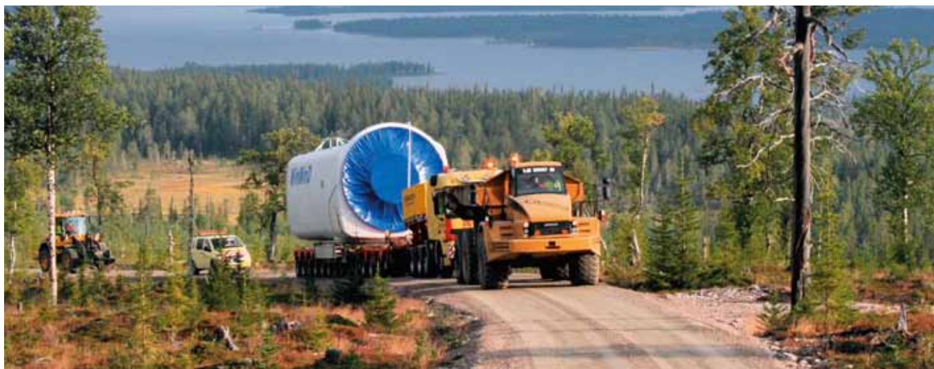
Kuva 5-12. Konehuoneen kuljetus. (Kuva © WinWinD)
