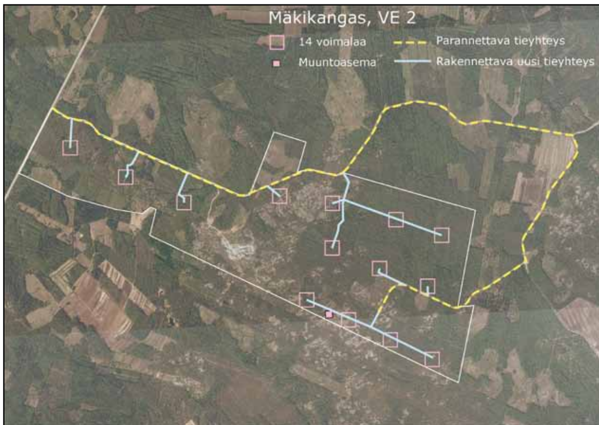
Kuva 5-4 VE 2 parannettavat ja uudet tieyhteydet.
