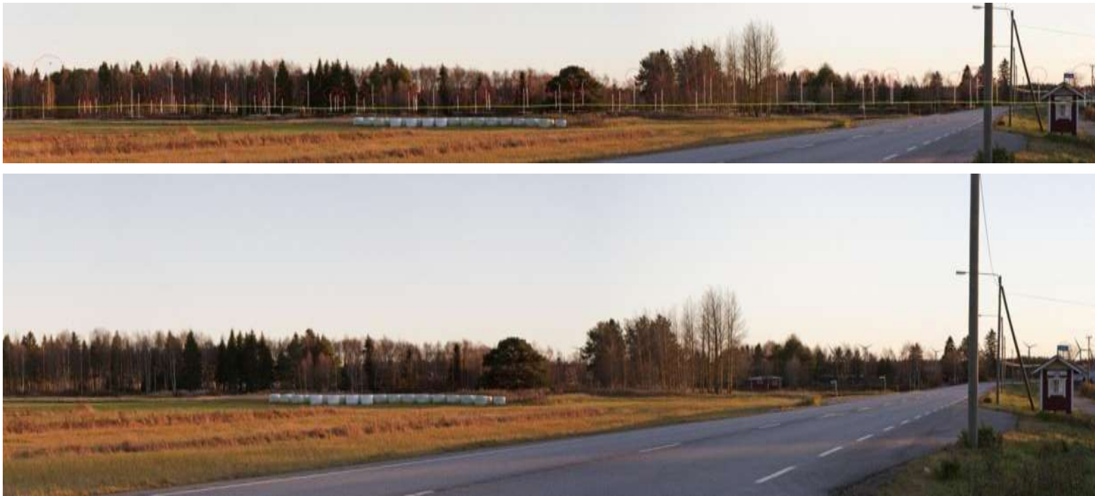
Kuva 4. Näkymä Uusitalon kohdalta valtatieltä 8 (kuvauspaikka 28). Yläkuvassa WindPro-luonnos voimaloiden näkyvyydestä ja alakuvassa valokuvasekvenssi samasta kuvasta kapeammalta sektorilta. Voimaloiden lavat ja tornin yläosa näkyvät paikoin puuston latvuston yläpuolella. Kasvillisuus katkaisee näkymät voimakkaasti. Etäisyys lähimpiin voimaloihin noin 3,4 km.
