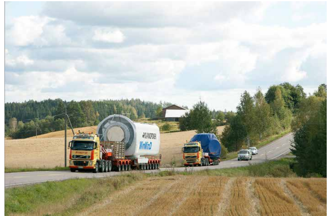
Kuva 97. Tuulivoimalan konebuoneen ja navan erikoiskuljetukset (Ville Silvasti Oy).
