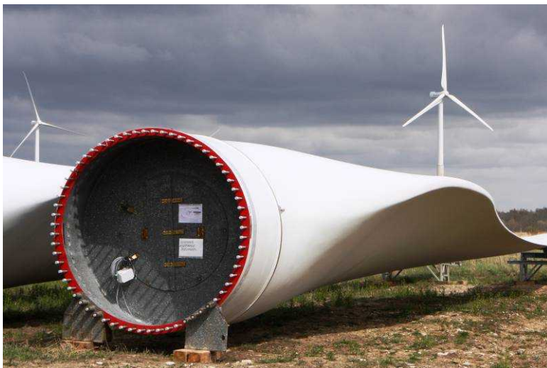
Kuva 5-7. Tiilivoimaturbiinin lapa odottamassa asennusta. (Kuva: WinWinD)
